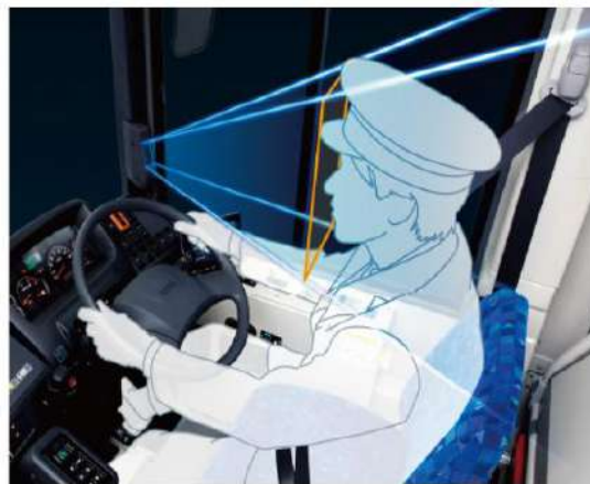
乗務員の脇見・閉眼・運転姿勢の検知も妨げない位置にカメラを設置
